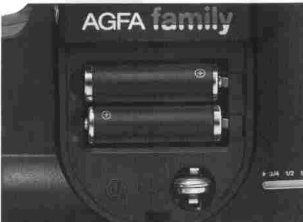
**Colocación de las pilas**
