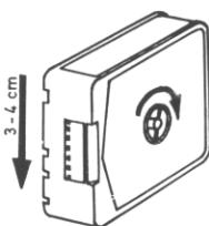
Estrarre il caricatore ed avvolgere a mano la pellicola per alcuni cm – avvolgere a mano in direzione della freccia, vedi fig. Inoltre smuovere un po' la bobina nel caricatore battendo leggermente.
