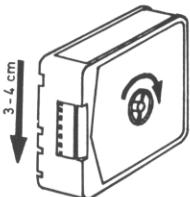
Filmkassette herausnehmen und Film von Hand um einige cm weiterschieben — in Pfeilrichtung von Hand aufwickeln, s. Abbildung. Zusätzlich durch leichtes Klopfen den Filmwickel in der Kassette lockern.
