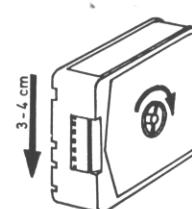
— d'enlever le chargeur et d'avancer le film de quelques centimètres-embobiner manuellement dans le sens de la flèche — voir illustration. Additionnellement débloquer le film en donnant de légers coups sur le chargeur.
