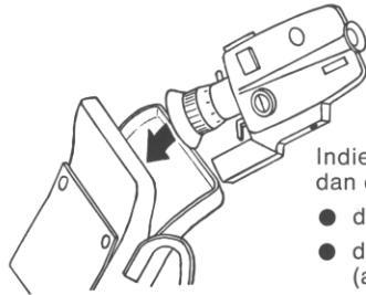
Let erop dat de filmcamera **steeds** met het objectief naar beneden in de tas wordt gestoken. – Dit is de beste beveiliging.
