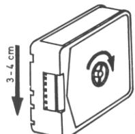
Tag ut filmkassetten och skjut fram filmen några cm för hand-spola upp för hand i pilens riktning, se bild. Knacka. Även litet lätt på kassetten för att underlätta uppspolningen.
