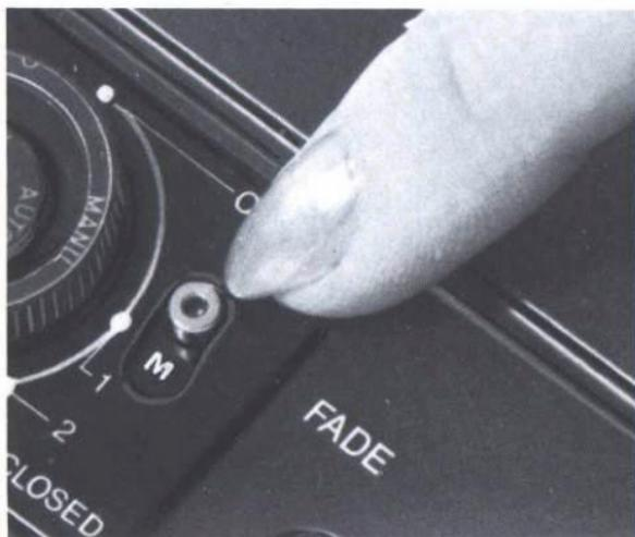
Das Speicherwerk, das mit Taste **24** gelöscht werden kann, registriert die Anzahl der Einzelbilder während des Abblendens. Würden Sie die Speicherung nicht löschen, stoppt die Kamera beim Aufblenden nach max. 90 Bildern.
