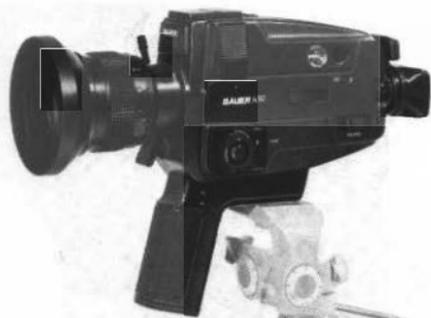
Für ruhige verwacklungsfreie Aufnahmen - besonders im Telebereich - ist es sehr empfehlenswert, Stativ und elektrischen Kabelauslöser zu verwenden. Das Stativgewinde **30** paßt für alle modernen Stative.
