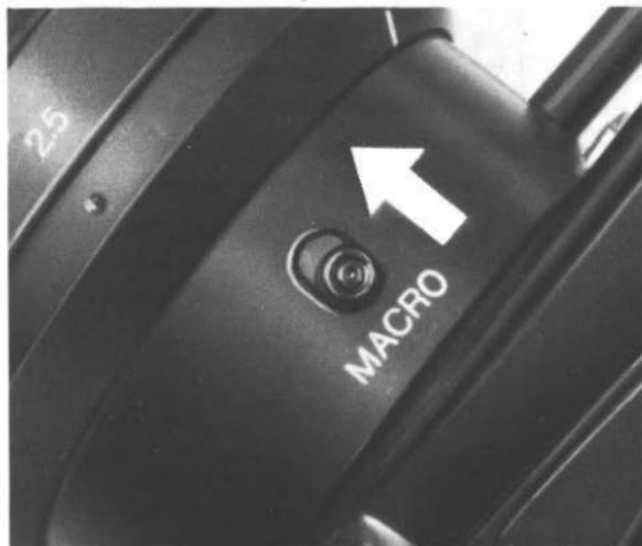
Nach Beendigung der Makro-Aufnahmen drehen Sie den Zoomring wieder nach links in die Teleposition.
