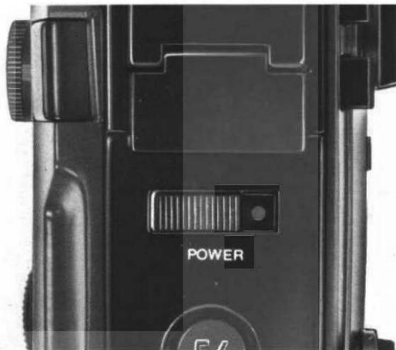
Bei längeren Aufnahmepausen **müssen** Sie zur Schonung der Batterien stets die Stromversorgung mit Hauptschalter 7 abschalten.
