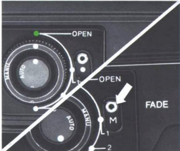
Steht Drehring 22 nicht in der richtigen Stellung, drehen Sie ihn manuell in die »Offenstellung« (»OPEN«). Zusätzlich muß das Speicherwerk durch kurzes Betätigen der Lösch-taste 24 ausgeschaltet werden. Das Speicherwerk wird nur beim Ab- Auf- und Überblenden benötigt.
