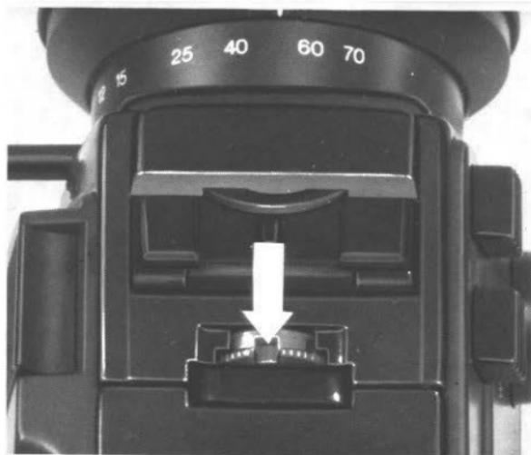
Der BAUER-Lichtregler sorgt dafür, daß Ihre Filme immer optimal belichtet werden. Film laufgeschwindigkeit, Bildwinkel und Filter werden dabei berücksichtigt, da das Aufnahmelicht unmittelbar vor dem Film gemessen und auf den richtigen Wert korrigiert wird. Die Automatik arbeitet, wenn unter der Abdeckklappe 6 das Blendenrad eingerastet ist. Die Abdeckklappe läßt sich nur dann schließen.
