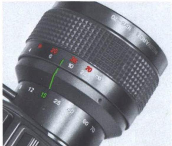
Eine auf dem Objektiv der Kamera markierte »Schnappschuß-einstellung« ermöglicht Ihnen das Filmen auch ohne genaue Entfernungseinstellung. Bei dieser Einstellung filmen Sie mit einer Schärfentiefe von 3,30 m bis  $\infty$  und einer Brennweite von 15 mm.
