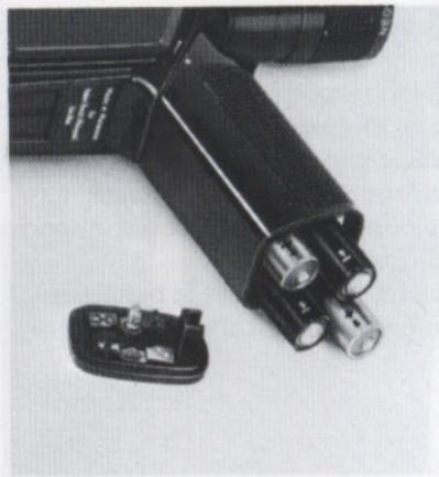
La corrente per tutte le funzioni elettriche ed elettroniche viene fornita da quattro pile mignon tipo AA da 1,5 Volt. Usi solo pile di elevata capacità, possibilmente al manganese alcalino. Si può far uso anche di accumulatori NC ricaricabili di misura e prestazione corrispondente.
