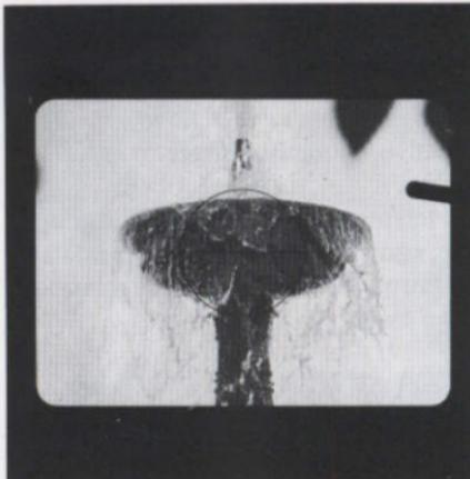
Giri l'anello di regolazione **1** dell'obiettivo, finché le due parti delle linee verticali non coincidono nel telemetro. La distanza sarà ora regolata correttamente.
