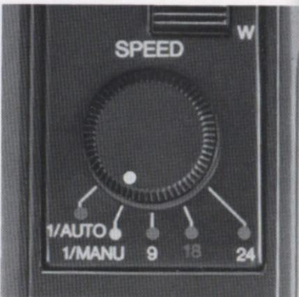
**Scattando manualmente fotogrammi singoli**, ad ogni azionamento dello scatto viene impressionato un solo fotogramma.
