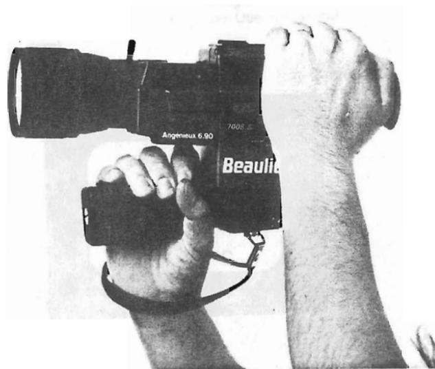
Das Photo demonstriert das Halten der Kamera beim Filmen. Der Stromhauptschalter wird hierbei automatisch eingeschaltet (beim Aufliegen auf der Hand). Dies bedeutet, daß alle Kamerafunktionen mit Strom versorgt werden. Sie müssen jetzt lediglich auf den Auslöseschalter drücken. Benützen Sie möglichst immer die Kamerahandschleife, da diese beim Tragen und Filmen die Kamera sichert.
