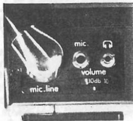
An der DIN-Norm-Buchse „MIC-line“ können außer einem Mikrofon zusätzliche Tonquellen angeschlossen werden. Z. B. Kassettenrecorder, Tonbandgerät oder Plattenspieler mit Vorverstärker, etc. Sie können so beispielsweise den außergewöhnlich reizvollen Effekt der Playback-Aufnahme nutzen. Zusätzlich ist es möglich, zwei Tonquellen direkt in der Kamera zu mischen (38 und 39). Die Tonkontrolle erfolgt hier ebenfalls über Kopfhörer.
